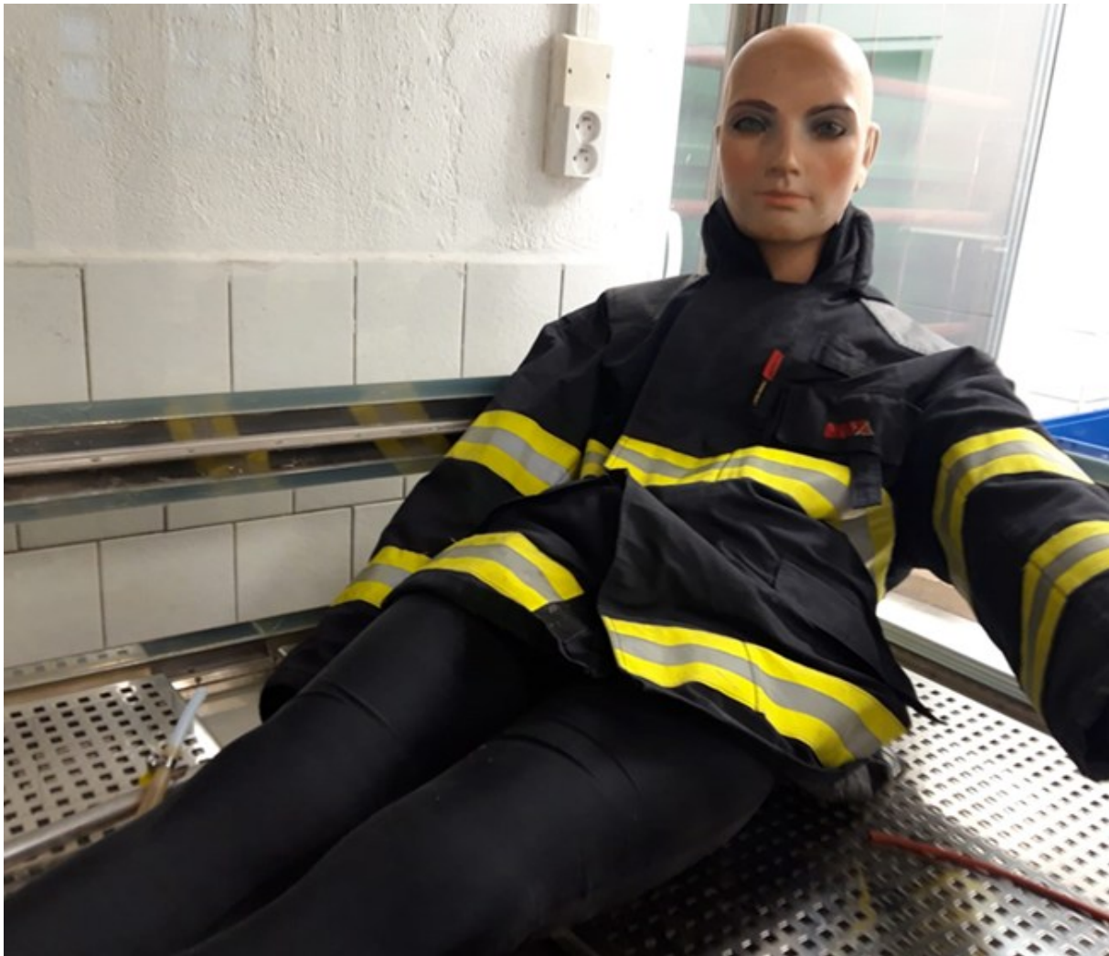
Obrázek 3 Modelové zkoušky kontaminace zkušební figuríny v hermetické komoře
